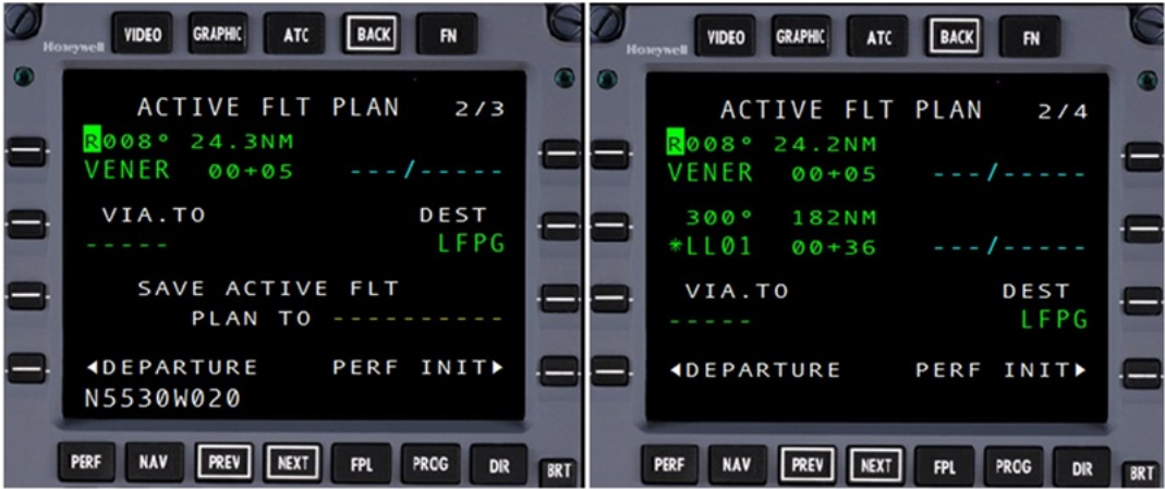
Figure 7 – Manual Entry of a Latitude and Longitude Waypoint
